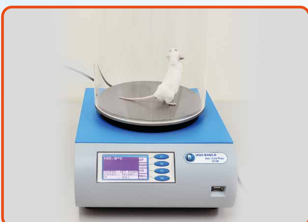
Imagen 6.- Plancha caliente con ratón en experimentación
